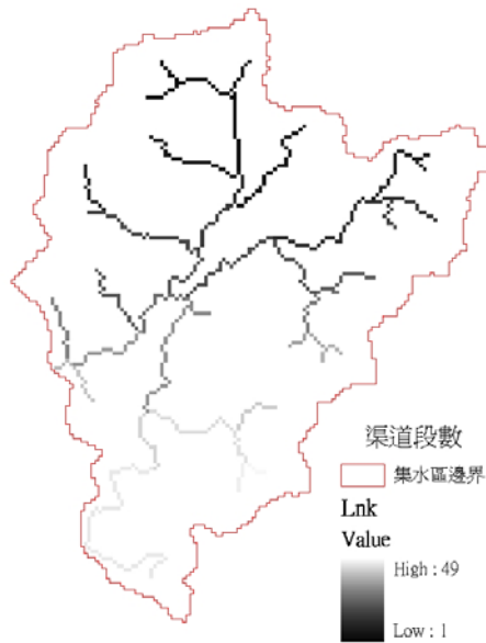
圖 3.5 河道製作流程圖，(a) 為流向圖層，以不同顏色之網格數字表示河川流向。(b) 為累積流量圖層，網格數字表示網格水體量，顏色越黑表示水體量越少，反之越多。(c) 為渠道圖層，其值為渠道段數
