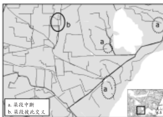
圖 2 現有灌溉渠道數值資料常見的空間錯誤
