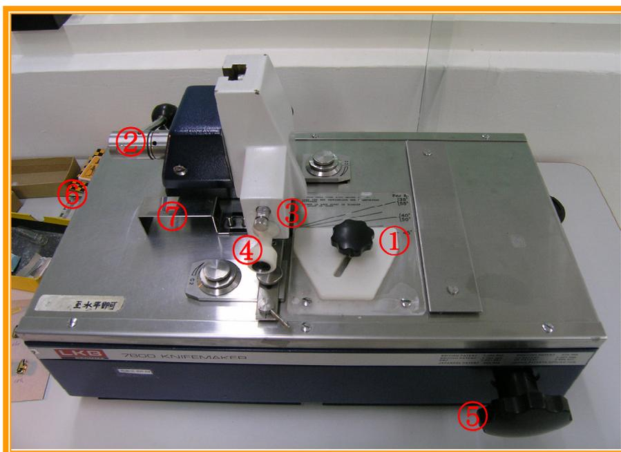
6. 扳手放鬆（往牆壁方向扳）及將④向內推回去（往自己反方向）。
