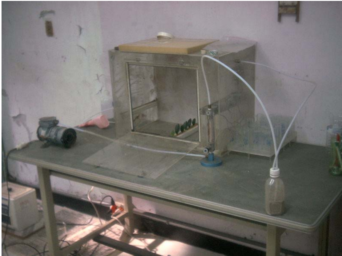
圖 3-2：人工揚塵箱及揚塵器構造實圖。
