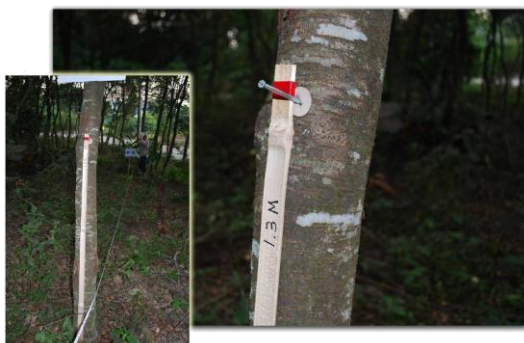
圖12. 使用 1.3 公尺之輔助桿確保量測高度
