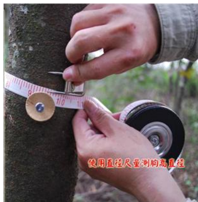
圖13. 使用直徑尺量測胸高直徑的作業情形
