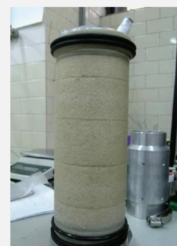
圖9. 安置加勁材後的砂質試體
