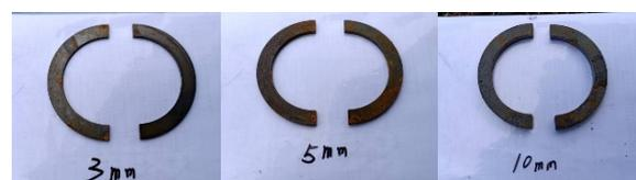
圖十四 地錨複拉使用鋼墊片厚度
