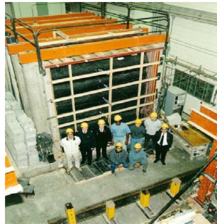
圖五 回包式加勁擋土牆試驗照片與示意圖(Bathurst et al., 2006)
