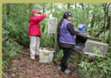
照片：坡面土壤水分變化監測
