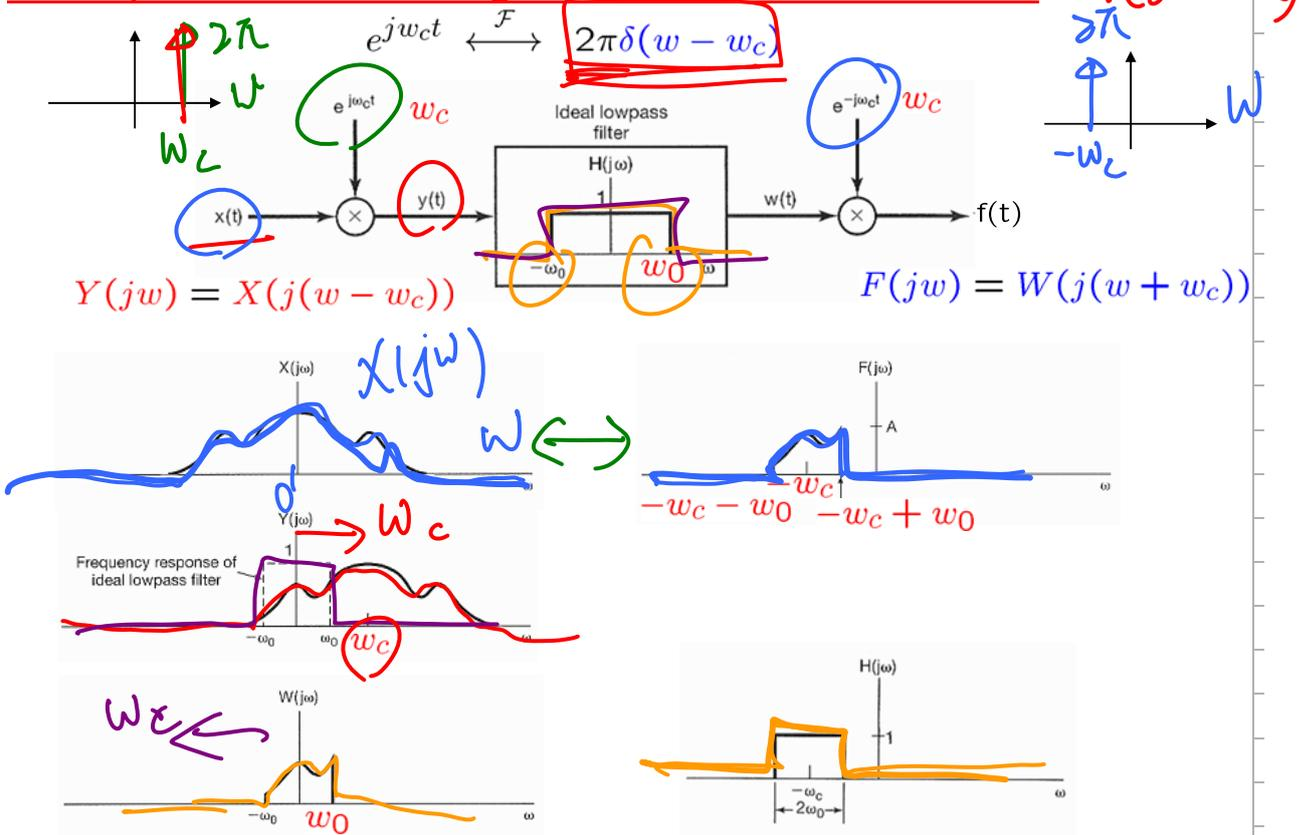
**Bandpass Filter Using Amplitude Modulation:**
