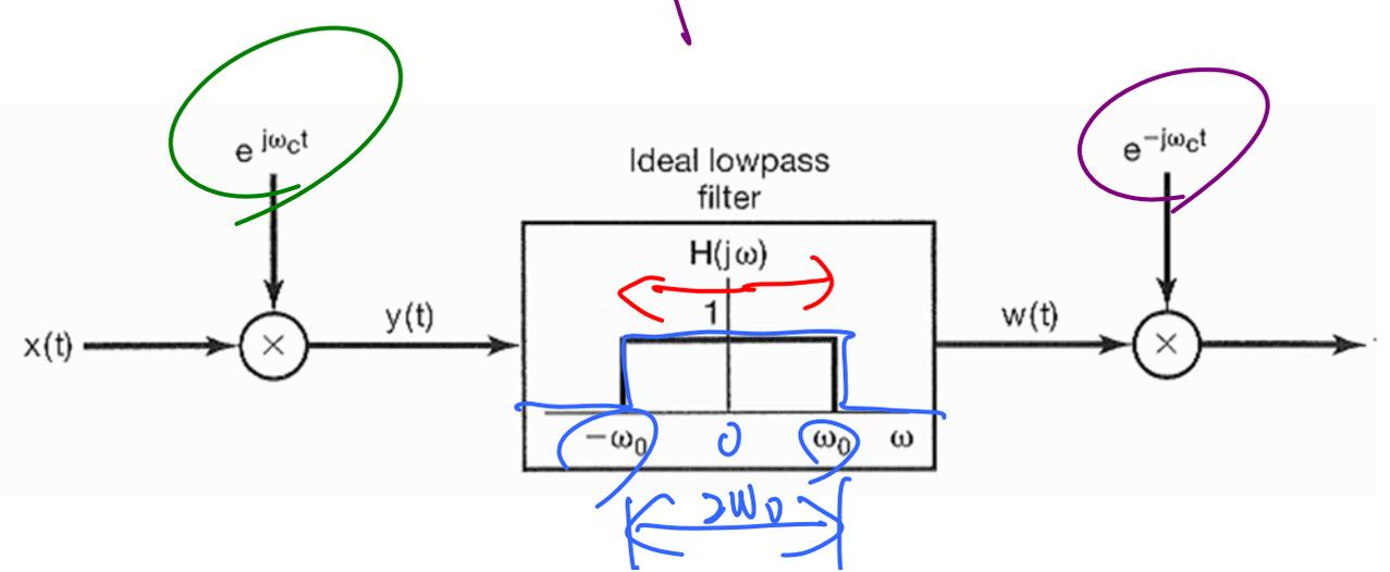
**Bandpass Filter Using Amplitude Modulation:**
