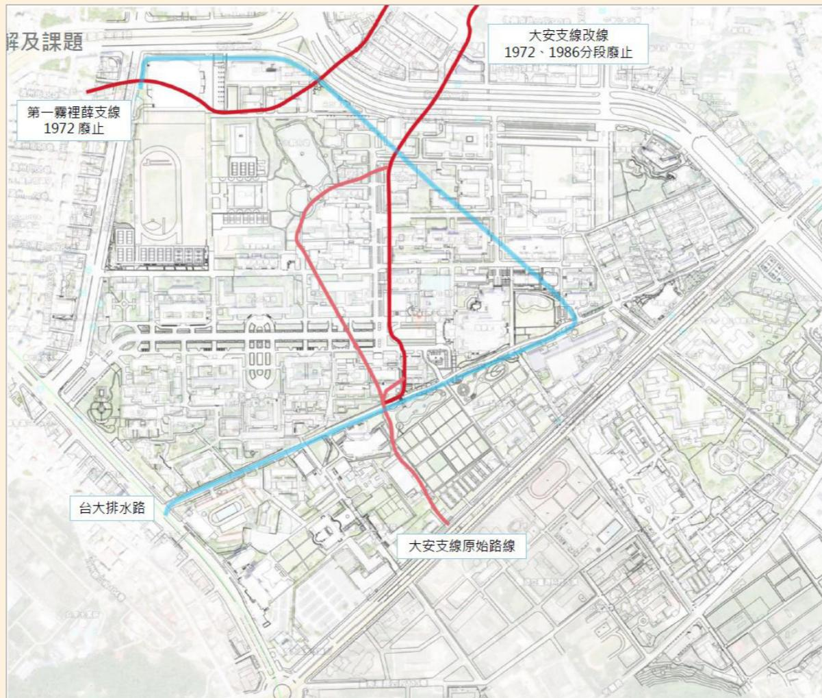
校總區的水圳多數已封閉成為主要的排水幹管，水工所東側的水圳是僅剩未加蓋的圳道，但池底淤泥嚴重、水不流動、兩旁雜草叢生，因此規劃將舊圳道水流與生態池流通，並設立解說牌讓大眾瞭解此段現存圳道之史實與價值。
