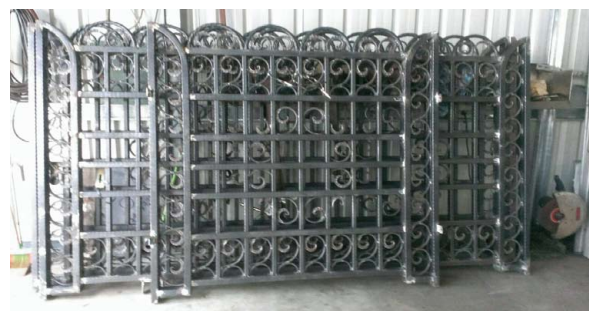
施工廠商第一次製作柵欄門
