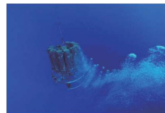
►「鹽溫深儀」及附帶之採水瓶自「海研一號」放出進行海水採樣探測。
