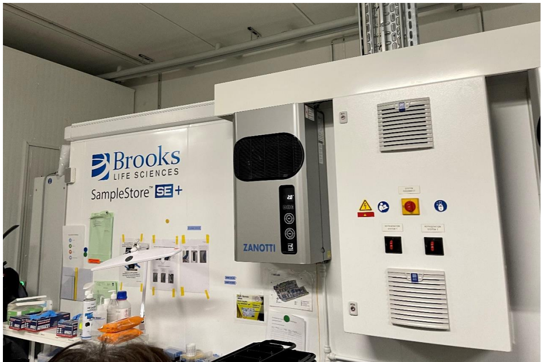
圖十七、丹麥國家生物資料庫採用先進的 Brooks SampleStore SE+ 自動化檢體儲存系統。
