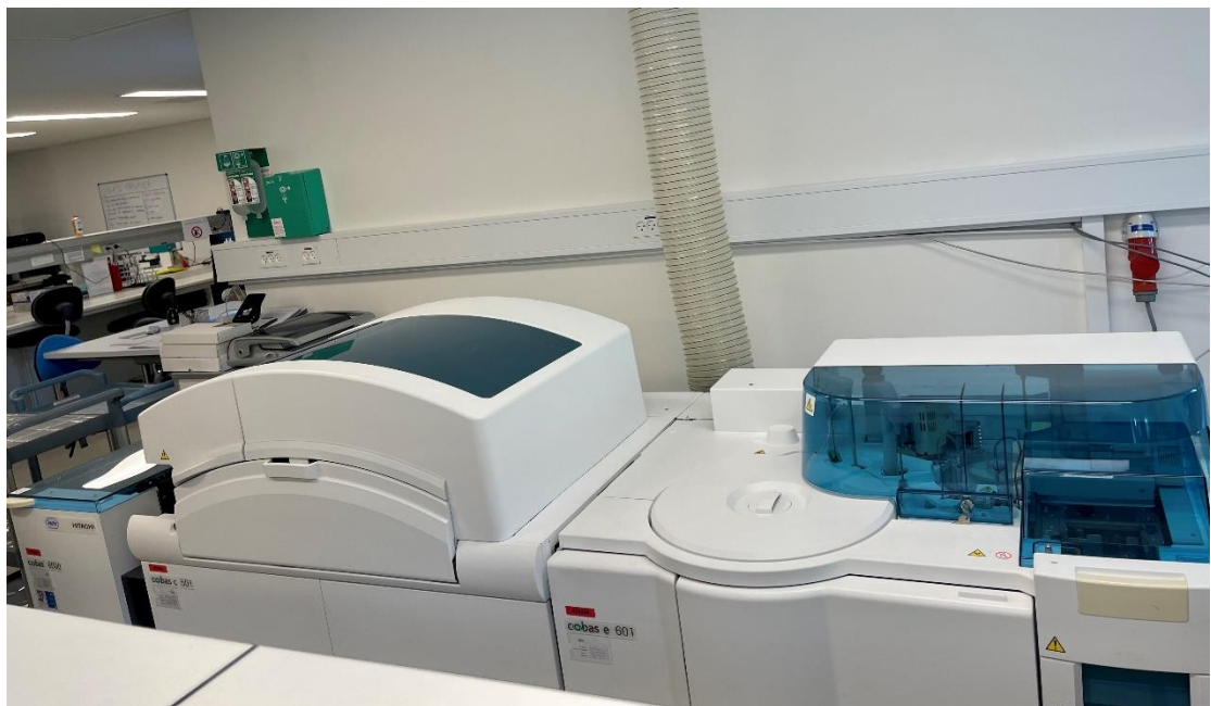
圖十八、丹麥國家生物資料庫採用 Roche 全自動模組化生化免疫分析儀 Cobas 6000 串聯 Cobas c501 同時進行臨床生化與血清免疫檢測。
