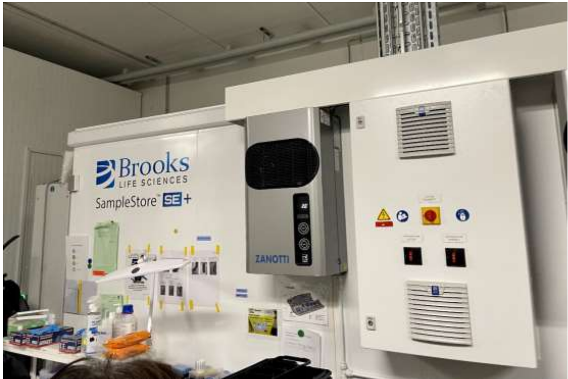
圖十七、丹麥國家生物資料庫採用先進的 Brooks SampleStore SE+ 自動化檢體儲存系統。
