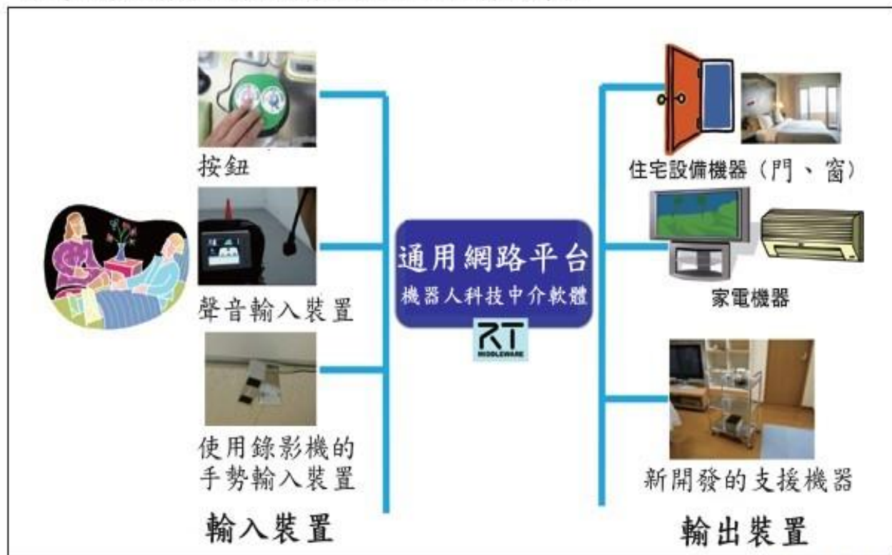
圖 透過機器人科技中介軟體所連結的smart house輸出入裝置
