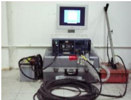
照片 2-1 SIR-10 透地雷達設備外觀(天線為 500MHz)
