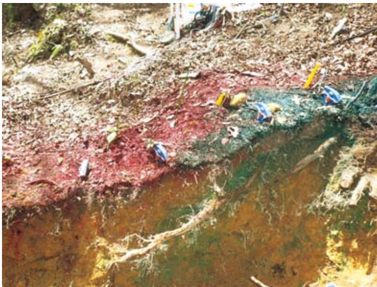
圖4 幹流水入滲之染色試驗(梁偉立 攝於日本京都市)
